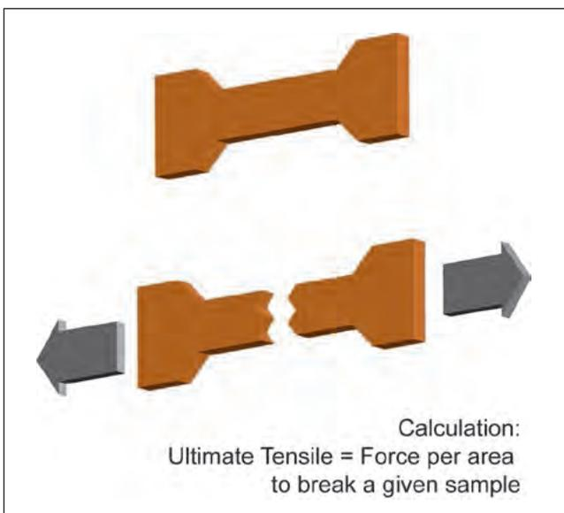
Figure 3-8. Tensile Strength
