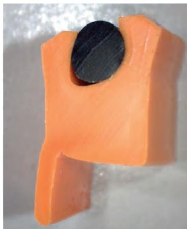
**Fig. 10-4. Seal Extrusion**
